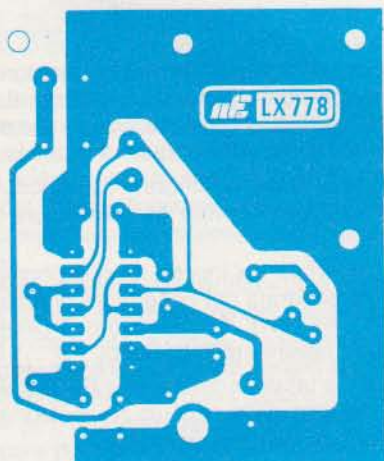
Fig. 4 Disegno a grandezza naturale del circuito stampato che risulta siglato LX.778.
